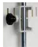
Dispositif qui permet de fixer la tige support de 12 mm de Ø.
