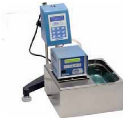
Utilisation d'un thermostat DIGITERM pour contrôler la température en mesure de viscosité au moyen de la re-circulation du liquide.
