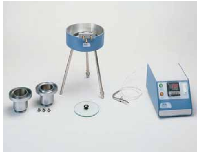
Coupes pour chauffage avec couronne à la base pour être adaptées au bain-marie et régulateur de température Electemp.
