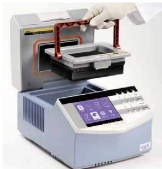
Thermocycleur porte ouverte, avec système de chauffage dans la contre-porte pour éviter les condensations.
