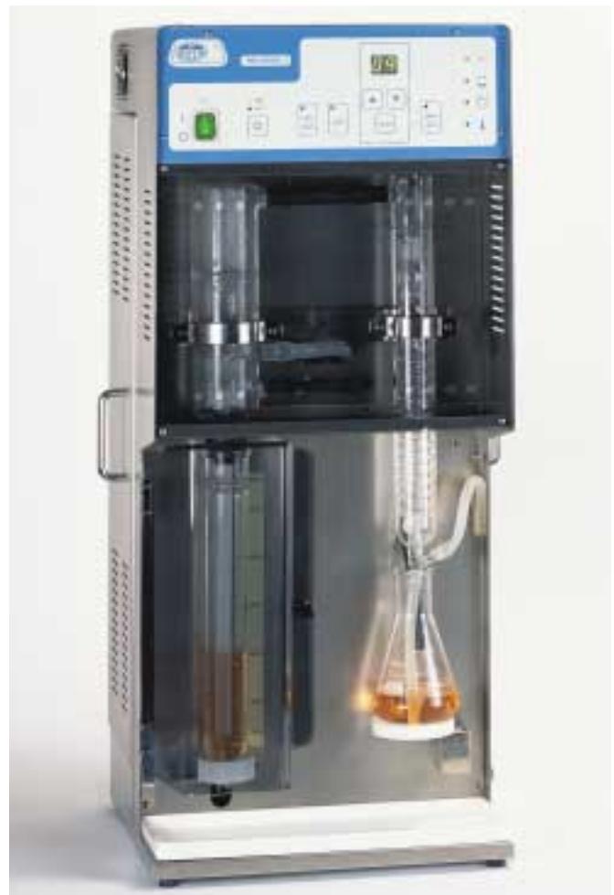
L'appareil est livré complet avec un tube à distillation de \varnothing 42 et 300 mm. de hauteur. Série MACRO.
